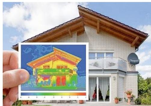
Ein Wärmebild macht deutlich, wo Energie aus dem Gebäude entweicht – und warum es sich lohnen kann, auch Fenster in eine Sanierung miteinzubeziehen
